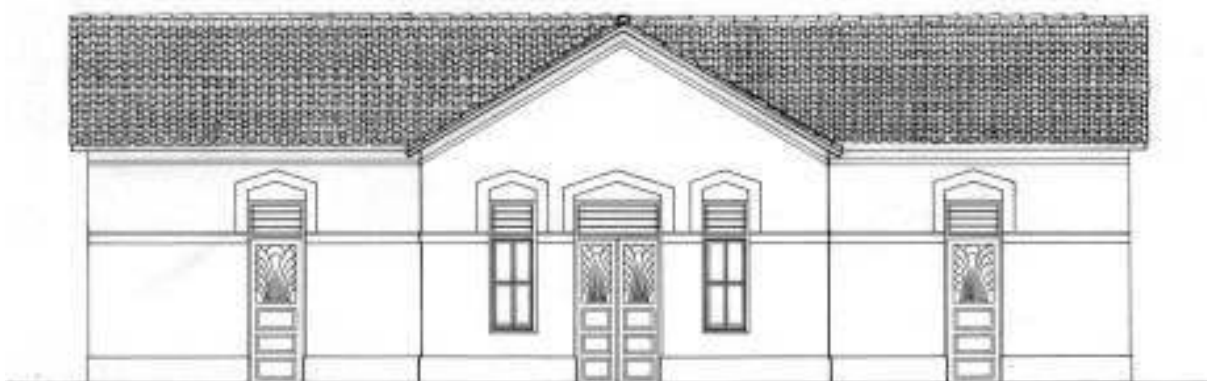
Σχέδιο της νότιας όψης του κτιρίου, σύμφωνα με την αποτύπωση του Ιωάννη Ιγγλέση (1977). Φαίνεται η παλαιά μορφολογία των κουφωμάτων, αλλά εντοπίζονται λάθη σε διαστάσεις και αναλογίες της όψης.
